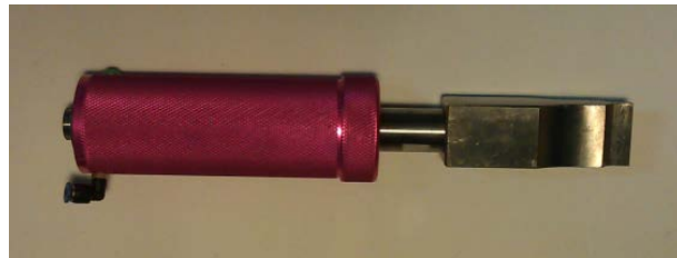
Generator si maner (element piezo + booster + sonotroda) - dispozitiv de lipit cu ultrasunete pentru produse medicale invazive utilizate in chirurgia toracica
